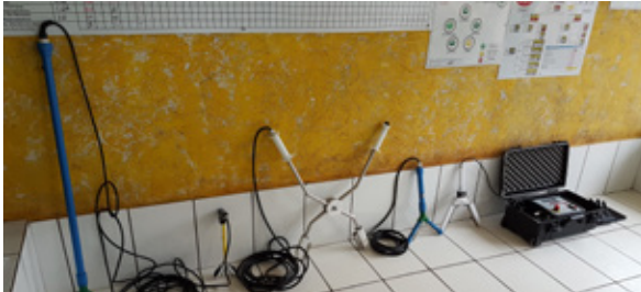
FIGURA 24 – À esq., eletrodo em má condição de conservação (ferrugem e oxidação) dificulta a passagem de corrente. À dir., eletrodo com adequado estado de conservação
