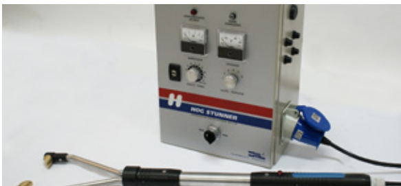
FIGURA 23 – Diferentes modelos de eletrodos para uso em diferentes categorias de suínos
