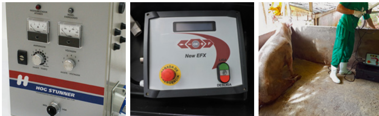
FIGURA 22- Modelo de um painel de controle de amperagem, voltagem e tempo de aplicação para garantia do sucesso da insensibilização elétrica
